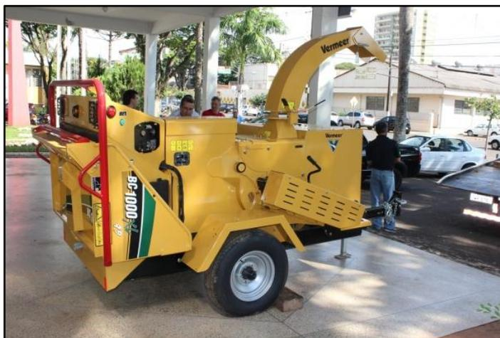
Figura 41 – Modelo de triturador de galhos existente no mercado.
